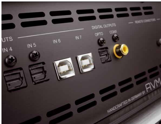
Zwei USB-Anschlüsse gibt's. Eine funktioniert treiberlos, die andere braucht welche, kann dafür 192 kHz
